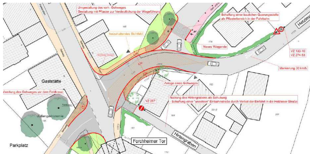
Abb. 7: Vorschlag Umbau Fahrbahnen im Kreuzungsbereich (Neuplanung Fahrbahn- ränder mit roten Linien dargestellt, Darstellung genordet, o. M.; Quelle: H & P)
